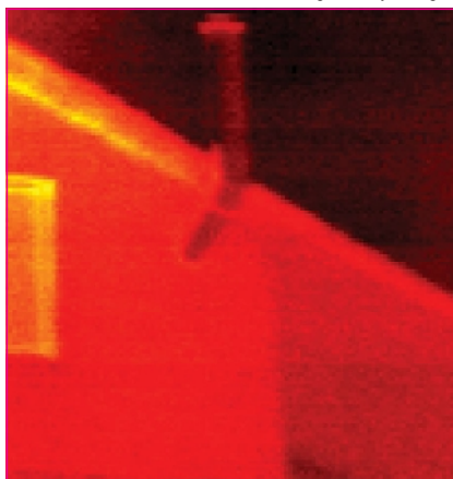
ТЕРМОГРАМА ФАСАДУ БУДИНКУ. Жовтим кольором виділено зони найбільшої втрати тепла, що потребують додаткової теплоізоляції.
